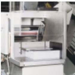
Margeur de pile
